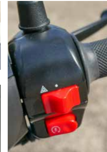
Alarmlichten zijn te activeren op het stuur
